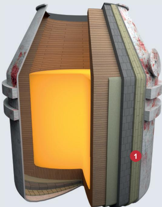
为了保护转炉的钢壳体并延长整个应用设备的寿命，转炉配以耐火和绝热内衬材料。首选的绝热材料必须能够抵抗转炉中较高的中间温度和相对较高的压缩力。
