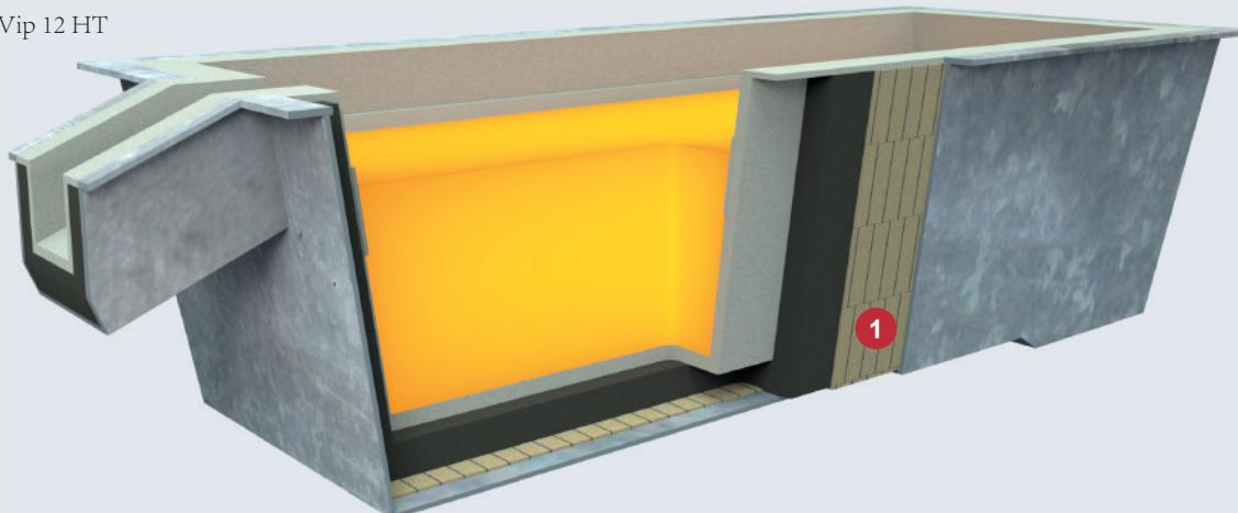
为了保护中间包周围的钢壳体并在浇铸之前获得适当的钢材温度，中间包配有耐火和绝热内衬材料。首选的绝热材料必须能够抵抗中间包中较高的中间温度和相对较高的压縮力。
